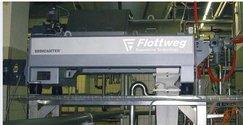
El SEDICANTER® FLOTTWEG para la recuperación de la cerveza
