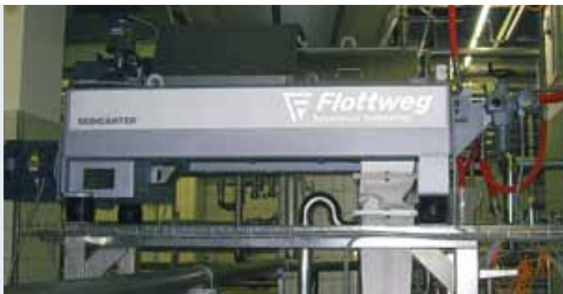
SEDICANTER® FLOTTWEG в процессе выделения пива из дрожжевой суспензии
