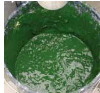
Концентрат микроводорослей после сепарации на тарельчатом сепараторе
