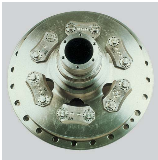
Mimośrodowo nastawiane płyty spiętrzające (opatentowane)
