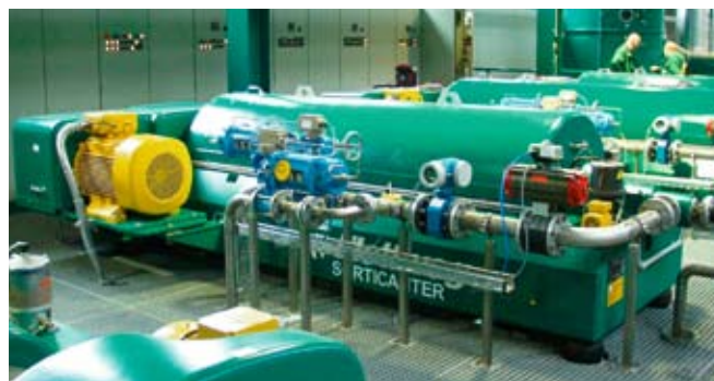
SORTICANTER® FLOTTWEG modello K6E per il riciclaggio della plastica
