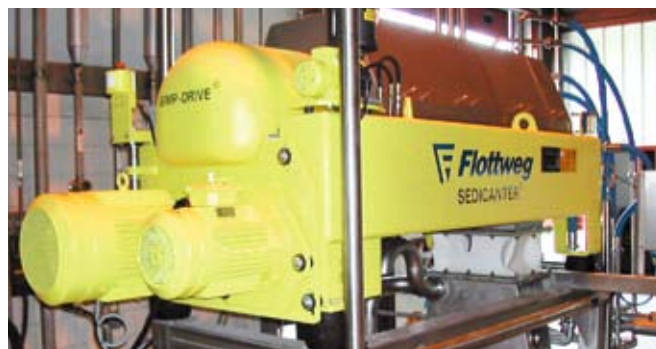
SEDICANTER® FLOTTWEG modello S4 E per il recupero di birra
