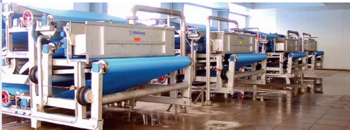
PRESSE A NASTRO FLOTTWEG per l'estrazione di succo di mela.
