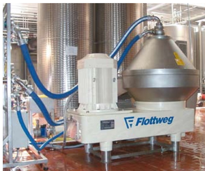
CENTRIFUGA A DISCHI FLOTTWEG modello AC2500 per la chiarificazione di succo di frutta e sidro
