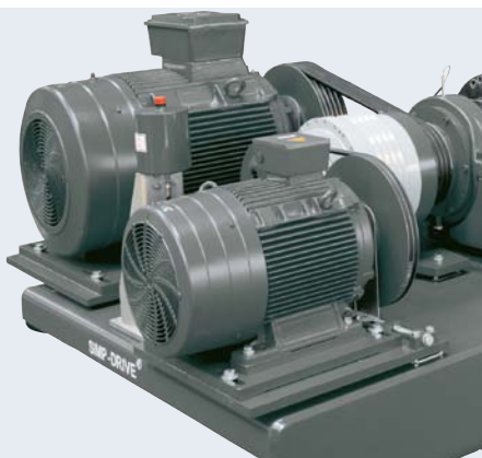
Contrôle de la vitesse différentielle par le SIMP-DRIVE® FLOTTWEG
