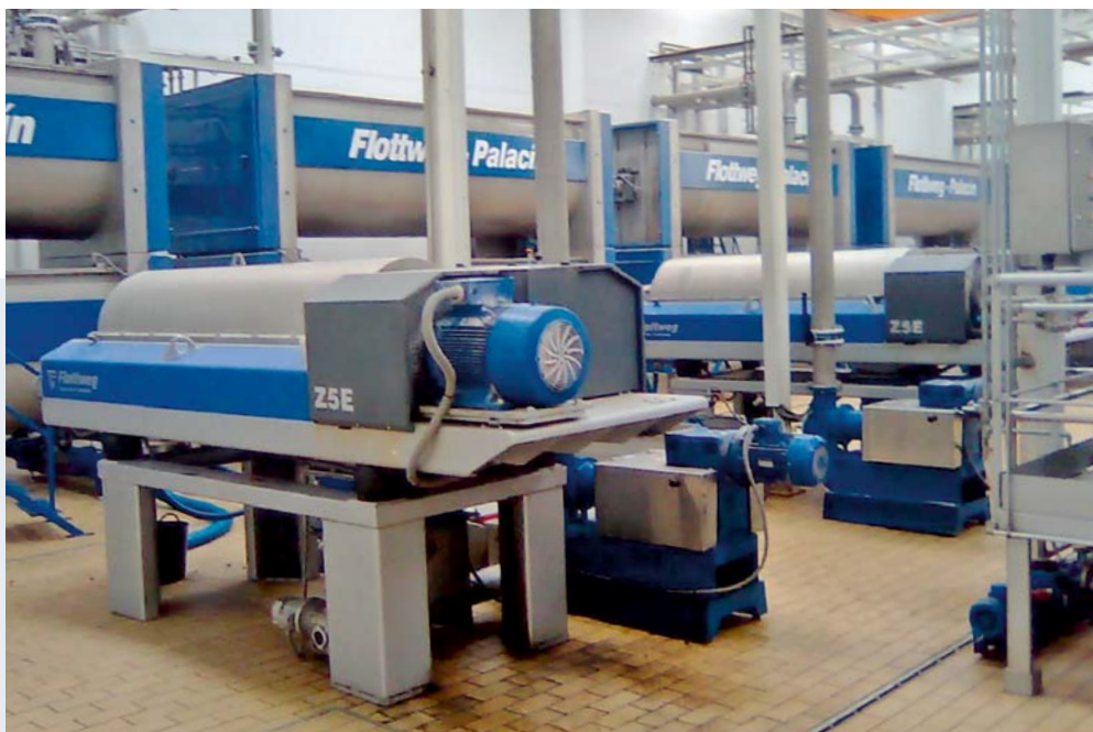
Les DECANTEURS FLOTTWEG dans une usine de production d'huile d'olives typique en Espagne
