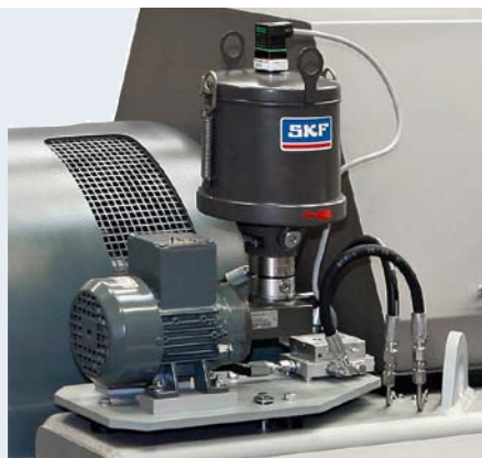
Dispositif de graissage automatique
