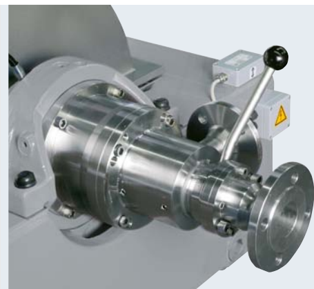
Turbine centripète réglable
