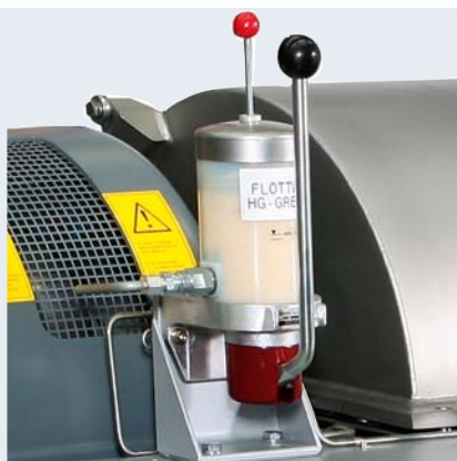
Dispositif de graissage manuel centralisé
